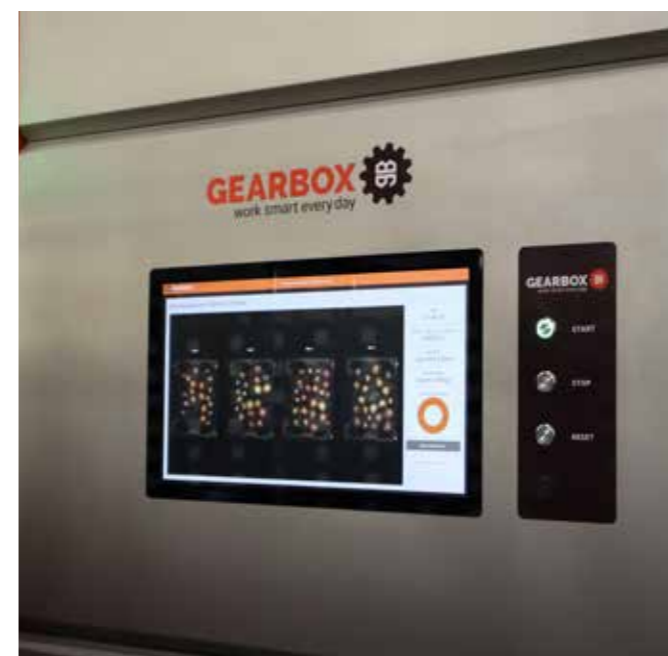
De GearStation controleert met een camerabox de punnets van alle kanten
